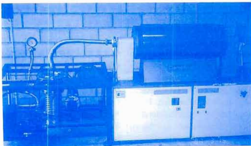
รูปที่ 7 เตาเผาหลอมระบบสุญญากาศ ใช้ไฟฟ้าขนาด 6 กิโลวัตต์ ซึ่งผู้เขียนได้รับบริจาคมา
