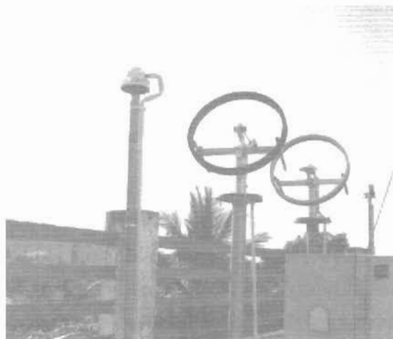
รูปที่ 1 แสดงสถานีวัดรังสีดวงอาทิตย์ที่จังหวัดเชียงใหม่ ของห้องปฏิบัติการวิจัยฟิสิกส์บรรยากาศ
