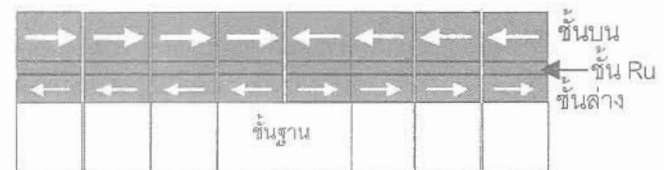
รูปที่ 6 แสดงชั้นฟิล์มบางสารแม่เหล็กเฟร์ไรท์ใช้บันทึกข้อมูล (ชั้นบน) วางตัวเหนือชั้นฟิล์มสารแม่เหล็กแอนติเฟร์โร (ชั้นล่าง) โดยมีชั้นของรูเธเนียม (Ru) ซึ่งไม่ใช่สารแม่เหล็กคั่นกลาง (ดัดแปลงจาก [1])
