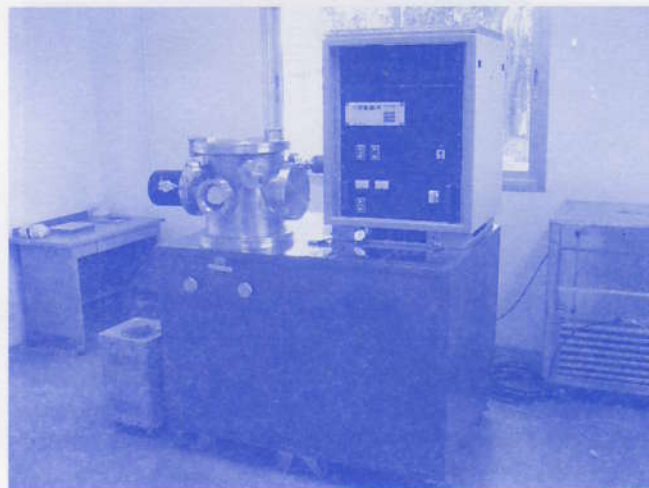
เครื่องเคลือบในสุญญากาศระบบสปีดเตอริงสำหรับงานวิจัยต้นแบบอุตสาหกรรม
