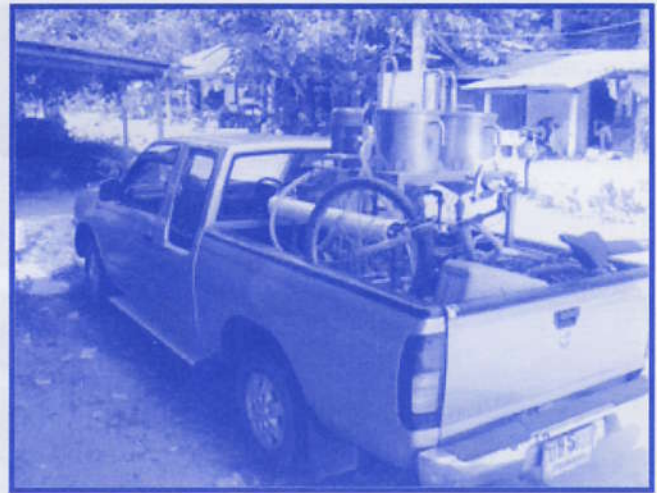
รูปที่ 2 ระบบนาโนฟิวเดรชันแบบเคลื่อนที่ได้ผลิตน้ำดื่มปลอดสารหนู ที่อำเภอรัตนพิบูลย์ จังหวัดนครศรีธรรมราช
