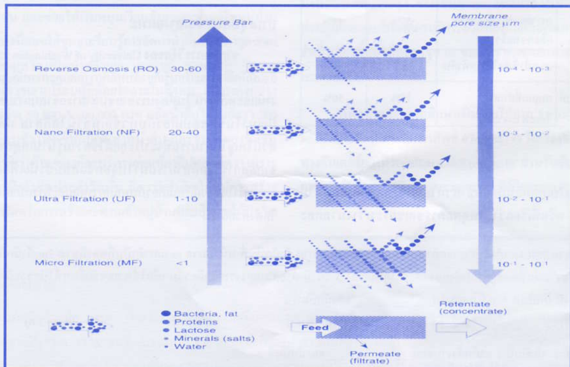
รูปที่ 1 แสดงระดับความดัน (ถูกตรึงที่ข้างขึ้น) ของระบบแยกระดับไมโคร (MF) อัลตรา (UF) นาโน (NF) และรีเวอร์ส ออสโมซิส (RO) ที่แปรผันกลับกับขนาดของรูเมมเบรน (ถูกตรึงที่ข้างลง) (1 bar = 100 kPa ~ 10' เท่าของความดันบรรยากาศ)
