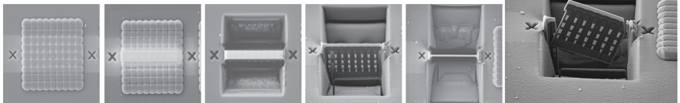
รูปที่ 1 ขั้นตอนการตัด เจาะ เตรียมชิ้นงานภายในเครื่อง FIB [1]
