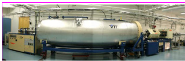
เครื่องเร่งอนุภาคแบบแทนเดิมขนาด 1.7 MV ชนิด Pelletron ที่ผมใช้ในการศึกษาวิจัยในช่วงหลัง
