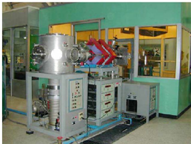
รูปที่ 3 เครื่องเร่งอนุภาค / ไอออนขนาด 150 kV ที่สร้างขึ้นเองที่ภาควิชาฟิสิกส์ คณะวิทยาศาสตร์ มหาวิทยาลัยเชียงใหม่ เพื่อนำมาใช้ในการชักนำการกลายพันธุ์ในพืช ถ้าซื้อจากต่างประเทศจะมีราคาประมาณ 25 ล้านบาท เนื่องจากเครื่องนี้ไม่เกี่ยวข้องกับรังสีที่มีอันตรายจึงอยู่ในอาคารธรรมดาได้
