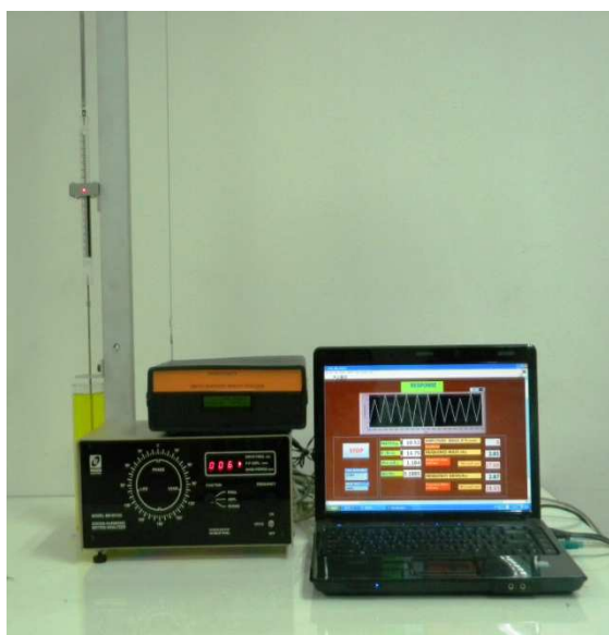
รูปที่ 2 ชุดอุปกรณ์การทดลองการเคลื่อนที่แบบฮาร์โมนิกที่ได้รับการติดตั้งระบบตรวจจับด้วยคอมพิวเตอร์
