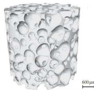
รูปที่ 5 ภาพถ่าย X-ray microtomography แสดงลักษณะ โครงสร้างแก้วชีวภาพรูพรุนโครงร่างสามมิติที่ขึ้นรูปด้วยโฟม (Bioactive glass foam scaffold) [19]
