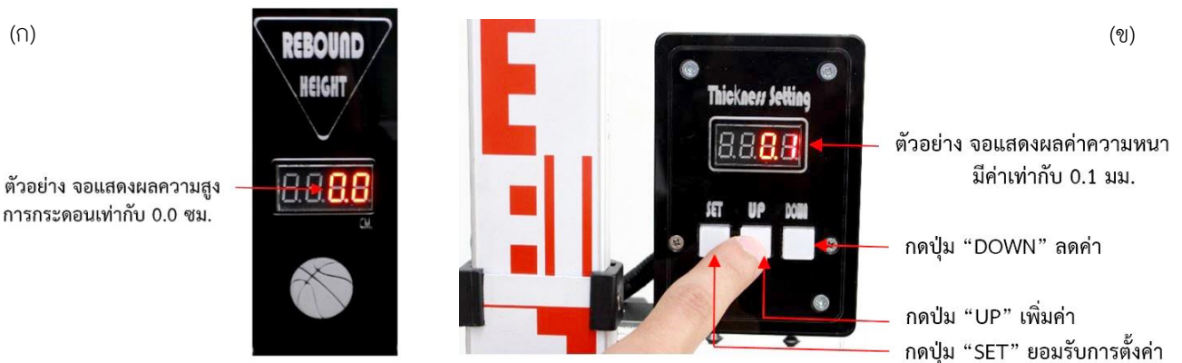
รูปที่ 4 (ก) หน้าจอแสดงผลค่าความสูงของการกระดอน และ (ข) หน้าจอแสดงผลการตั้งค่าความหนาแผ่นยางปูสนามฟุตซอล
