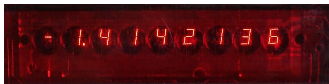
รูปที่ 2 ตัวอย่างการนำแอลอีดีสีแดงมาใช้ในหน้าจอแสดงผลของเครื่องคิดเลข (ที่มา: wikimedia – David R. Tribble)
