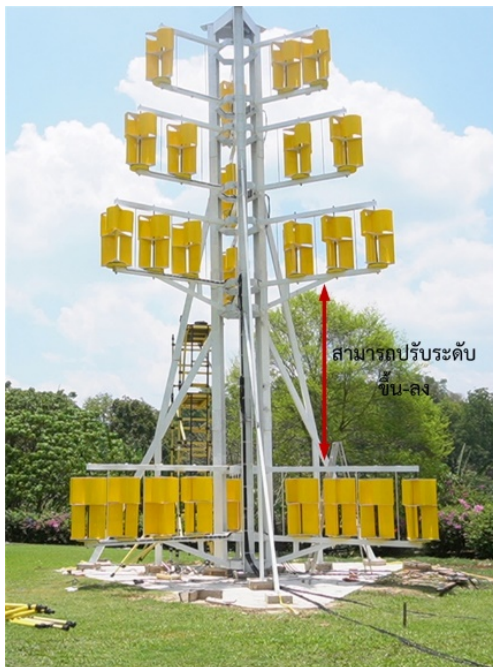
รูปที่ 3 การออกแบบเสากังหันลมแนวแกนตั้ง โดยให้แขนที่รองรับชุดกังหันลมสามารถเคลื่อนขึ้นลงได้ทั้ง 4 ชั้น
