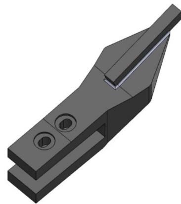
รูปที่ 6: แบบฟันชุดบั้งก็้หมุนติดตั้งวัสดุเสริมแรง 3D
