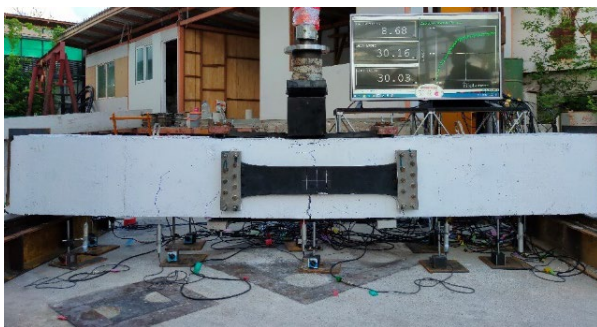
รูปที่ 10 : รูปแบบการแตกร้าวของ C-25R ที่กำลังดัดประลัย
