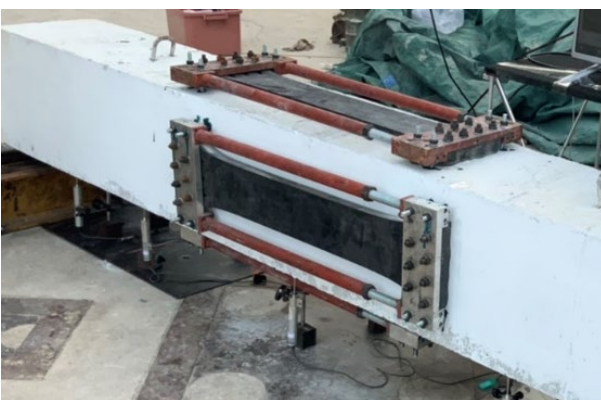
รูปที่ 4 : ตัวอย่างทดสอบที่ติดตั้งแผ่นยางพาราอัดแรง
