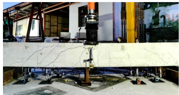
รูปที่ 8 : รูปแบบการแตกร้าวของ C-100 ที่กำลังดัดประลัย
