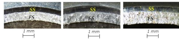
(d) Cutting edge of AA5052 from concave punch
