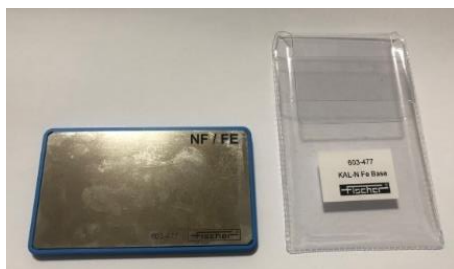
รูปที่ 4 : แผ่นสอบเทียบเครื่องวัดความหนาสำหรับวัสดุที่เป็นเหล็ก
