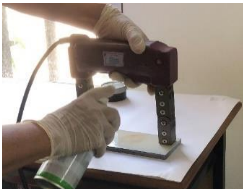
รูปที่ 13 : ลักษณะการฉีดพ่นอนุภาคแม่เหล็ก
