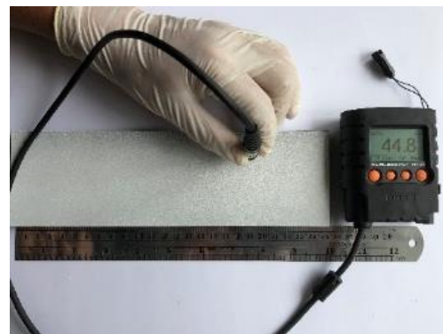
รูปที่ 11 : ลักษณะการวัดความหนาผิวเคลือบ
