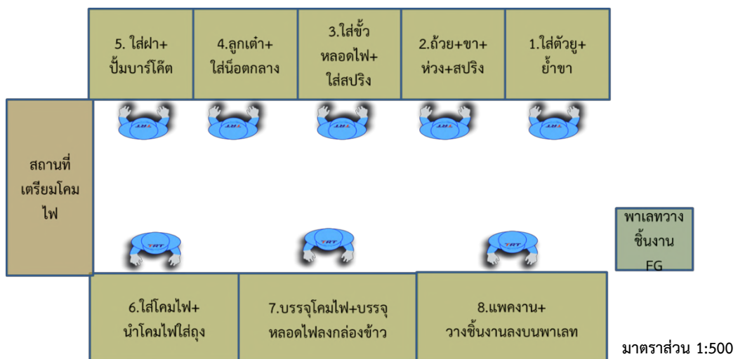
รูปที่ 11 : สายการผลิตประกอบงาน (หลังปรับปรุง)
