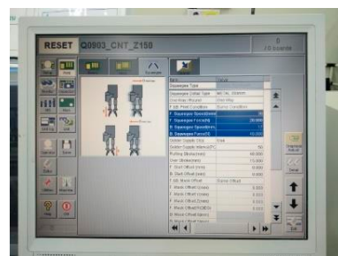
รูปที่ 11 การปรับตั้งค่าพารามิเตอร์ของเครื่องพิมพ์ตะกั่ว
