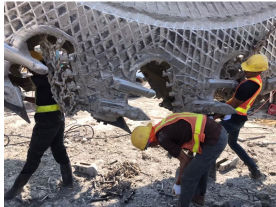
รูปที่ 1: ลักษณะการทำงานของฟันชุดบั้งกีหมุน
