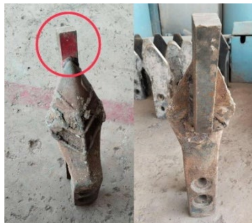
รูปที่ 2: ฟันชุดบั้งกีหมุนและการเสริมแรงด้วยวัสดุเหล็กเพลลา SS400 ในปัจจุบัน
