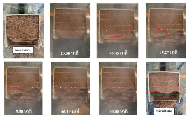
รูปที่ 8 : การพังทลายของแบบจำลองมวลดินบดอัดที่หน่วยน้ำหนัก 18.34 \text{ kN/m}^3 ระดับน้ำฝน 220 มิลลิเมตรต่อชั่วโมง
