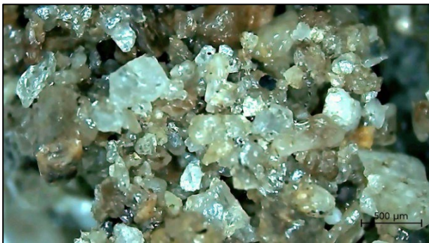
รูปที่ 13 : ภาพตัดขวางของ EPS มอร์ตาร์โดยตัวทำละลายอินทรีย์ ไดคลอโรมีเทน ที่ปริมาณโฟม 5%
