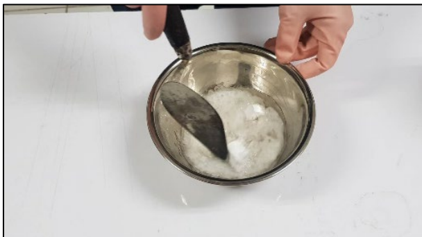
รูปที่ 4 : ละลายโฟมในตัวทำละลายอินทรีย์
