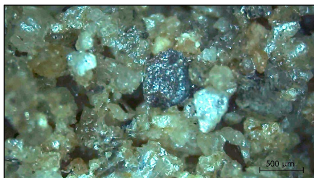
รูปที่ 14 : ภาพตัดขวางของ EPS มอร์ตาร์โดยตัวทำละลายอินทรีย์ ไดคลอโรมีเทน ที่ปริมาณโฟม 13%
