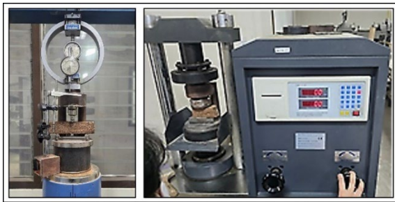
รูปที่ 7 : เครื่องมือทดสอบค่ากำลังรับแรงดัดและค่ากำลังรับแรงอัดของ EPS มอร์ตาร์
