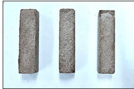
รูปที่ 6 : ก่อนตัวอย่างตามแบบการทดสอบมาตรฐาน ขนาด 40×40×160 มม.
