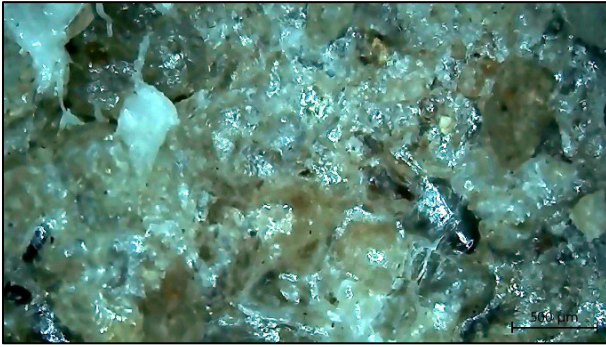
รูปที่ 12 : ภาพตัดขวางของ EPS มอร์ตาร์โดยตัวทำละลายอินทรีย์ แอซีโตน ที่ปริมาณโฟม 17%
