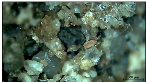
รูปที่ 10 : ภาพตัดขวางของ EPS มอร์ตาร์โดยตัวทำละลายอินทรีย์ แอซีโตน ที่ปริมาณโฟม 5%
