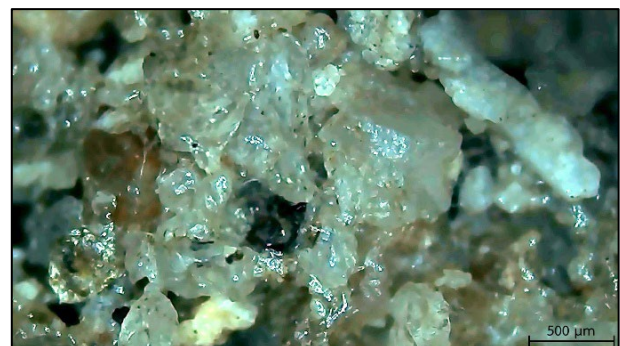
รูปที่ 11 : ภาพตัดขวางของ EPS มอร์ตาร์โดยตัวทำละลายอินทรีย์ แอซีโตน ที่ปริมาณโฟม 13%
