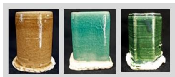
รูปที่ 14 : ผลการทดสอบเผาชิ้นรูปผลิตภัณฑ์เซรามิก
