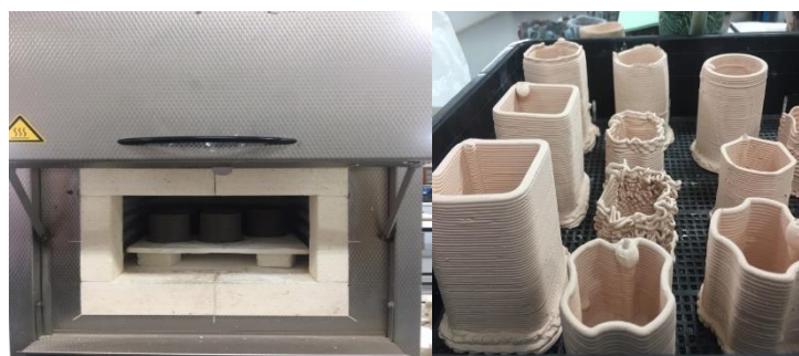
รูปที่ 9 : ทดสอบเผาผลิตภัณฑ์เซรามิก
