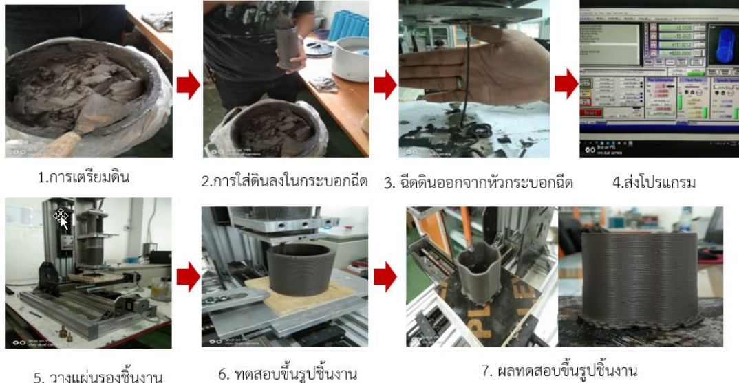
รูปที่ 8 : ทดสอบขึ้นรูปผลิตภัณฑ์เซรามิก
