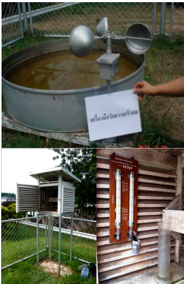
รูปที่ 4 เครื่องมือและอุปกรณ์สำหรับการวัดค่าการระเหยด้วยวิธีเพนแมน แหล่งที่มา : โครงการส่งน้ำและบำรุงรักษาลำตะคอง สำนักงานชลประทานที่ 8 กรมชลประทาน [5]
