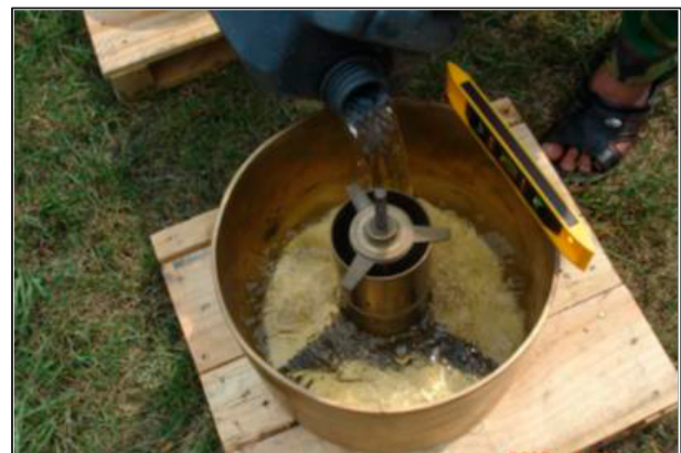
รูปที่ 5 เติมน้ำลงในถาดพร้อมติดตั้งเครื่องมือวัดระดับน้ำ (Hook gage)
