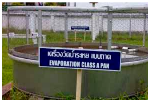
รูปที่ 1 ถาดวัดการระเหยแบบคลาส เอ (Evaporation Class A Pan) แหล่งที่มา : กรมอุตุนิยมวิทยา [3]
