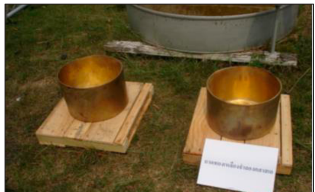
รูปที่ 3 ภาควัดการระเหยทองเหลืองโดยการจำลองแบบภาควัดคลาส เอ
