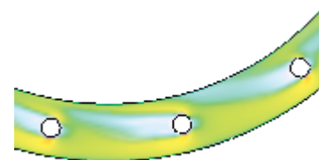
รูปที่ 8 เขตที่เกิดขึ้นจากตัวสร้างกระแสไหลวนภาคตัดกลม
