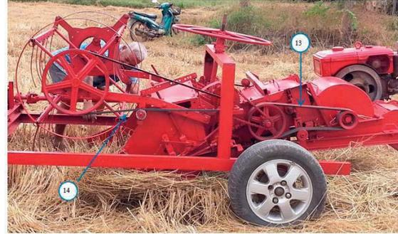
รูปที่ 2: ชุดต้นกำลังขับเคลื่อนเครื่องตัดสับฟางและตอซังแบบลากจูง
