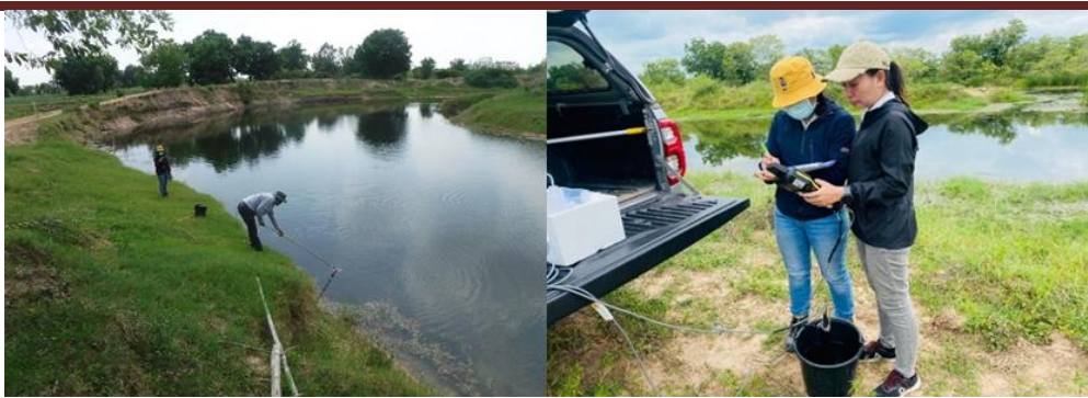
ภาพที่ 1 การตรวจวัดความเค็มของน้ำในบริเวณลำห้วยธรรมชาติข้างเคียงในพื้นที่ทำเกลือสินเธาว์
