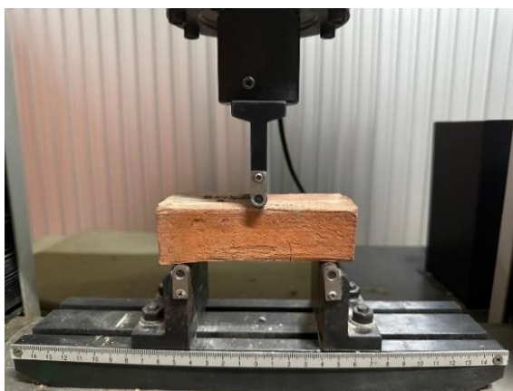
ภาพที่ 3 การทดสอบค่าความทนต่อแรงกดอัดของก้อนอิฐทดสอบ
