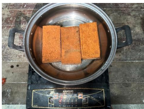
ภาพที่ 2 การทดสอบค่าการดูดซึมน้ำของก้อนอิฐทดสอบ
