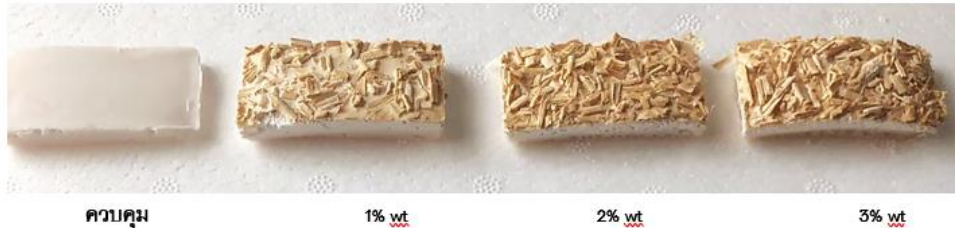
ภาพที่ 5 การกระจายตัวของเซลลูโลสจาก ก) ใยตาล และจาก ข) ป่านรามิ ที่ 1% 2% และ 3% wt. ในสารละลายแบ่งที่อัตราส่วนแบ่ง 1 : น้ำ 3
