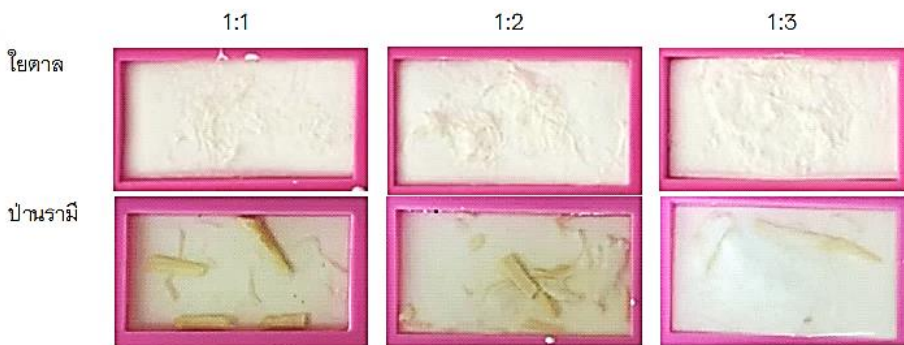
ภาพที่ 4 การกระจายตัวของเซลลูโลสจากไยตาลและจากปานรามิ (1% wt.) ในสารละลายแป้งที่อัตราส่วนต่างๆ
