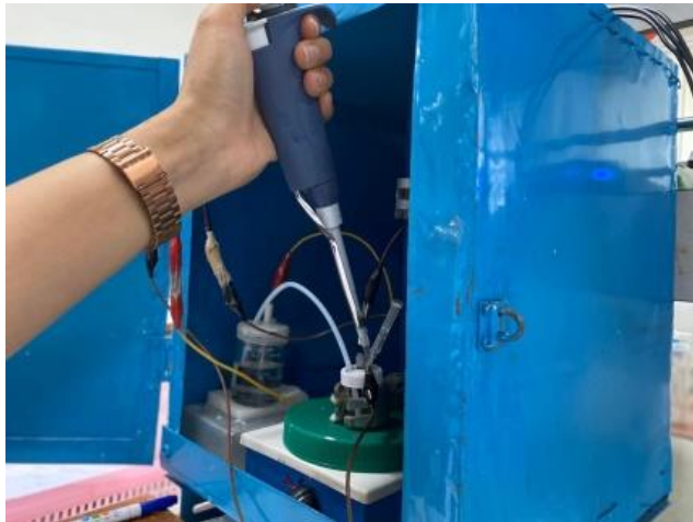
ภาพที่ 2 การเติมวิตามินซีลงในเซลล์เคมีไฟฟ้า
