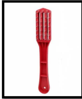
ภาพที่ 2 แปรงหัวตะปูที่ใช้ขูดแยกเส้นใยกันช่อดอกชก
