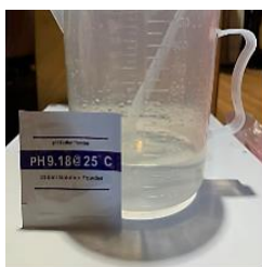
รูปที่ 4 การวัดค่า pH ของชุดความเป็นด่าง 9.18
