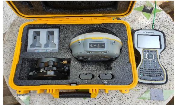
รูปที่ 4 เครื่องรับสัญญาณดาวเทียม GNSS-Trimble (R8s)
