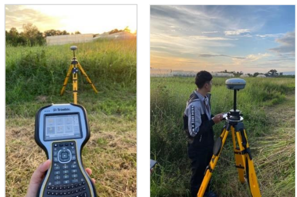
รูปที่ 6 การใช้เครื่องรับสัญญาณดาวเทียม GNSS ใน ระบบโครงข่ายการรังวัดด้วยดาวเทียมแบบจลน์ (RTK) ในการรังวัดค่าพิกัดหมุดควบคุม
