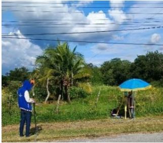
รูปที่ 7 รังวัดค่าพิกัดจุดควบคุมภาพและจุดตรวจสอบภาพถ่าย
