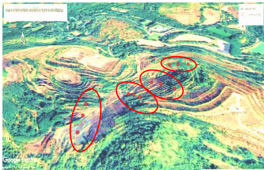
รูปที่ 3 ตำแหน่งของจุดทดสอบการเคลื่อนตัวของผนังเหมือง
