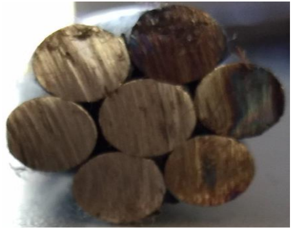
รูปที่ 2 ภาคตัดขวางของลวดเหล็กกล้าตีเกลียวสำหรับคอนกรีตอัดแรงชนิด 7 เส้น
