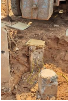
(ก) การติดตั้งตัวรับสัญญาณการทดสอบ
