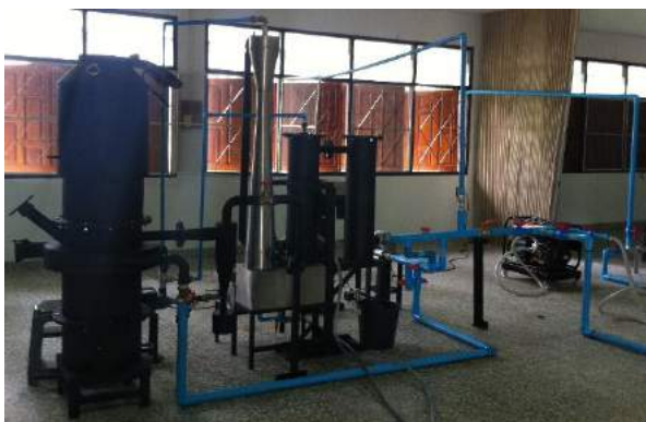
รูปที่ 7 เครื่องผลิตก๊าซเชื้อเพลิงจากหุ้เนเปียร์แบบไหลลงรุ่นสุดท้าย
