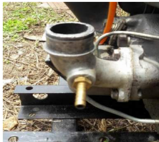
รูปที่ 4 การติดตั้งท่อไอเสียแบบ T-Type
