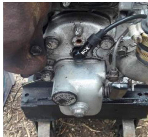
รูปที่ 8 ฝาสูบที่ทำการใส่หัวเทียนเรียบร้อยแล้ว
