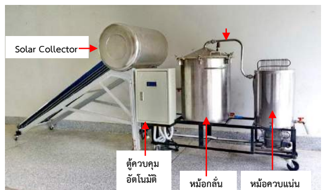
รูปที่ 13 การสร้างเครื่องกลั่นน้ำมันหอมระเหยสมุนไพร ร่วมกับตัวเก็บรังสีแสงอาทิตย์
