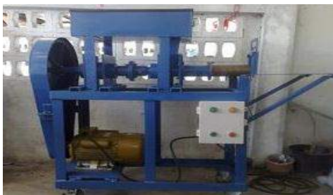
รูปที่ 3 เครื่องอัดขึ้นรูปเชื้อเพลิงถ่านอัดแท่งแบบเกลียวอัด
