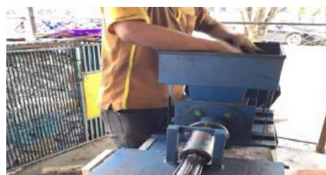
รูปที่ 6 การอัดขึ้นรูปเชื้อเพลิงถ่านอัดแท่ง
