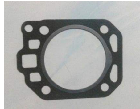
รูปที่ 7 เพิ่มประเก็นฝาสูบอีก 1 แผ่น หนา 4 mm
