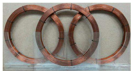
รูปที่ 4 ลักษณะขดตัวนำด้านส่งและรับกำลังงาน
