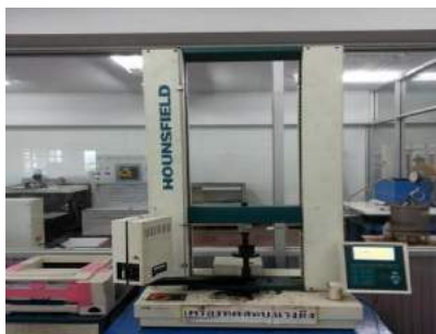
รูปที่ 9 การทดสอบหาค่าความแข็งแรงด้วยเครื่องทดสอบแรงดึงและแรงกด (ยี่ห้อ HOUNSFIELD)
