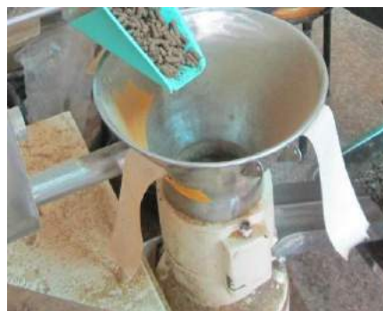
รูปที่ 6 เครื่องอัดเม็ดอาหารสัตว์ แบบ flat die
