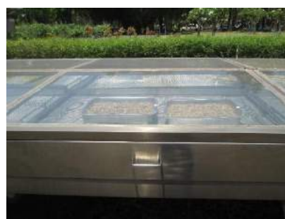
รูปที่ 3 การตากหญ้าเนเปียร์ที่ตัดบดหยาบในตู้อบแห้งพลังงานแสงอาทิตย์
