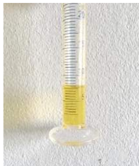
ก) การแยกน้ำมันหอมระเหย ข) ปริมาณน้ำมันหอมระเหยออกจากน้ำ
