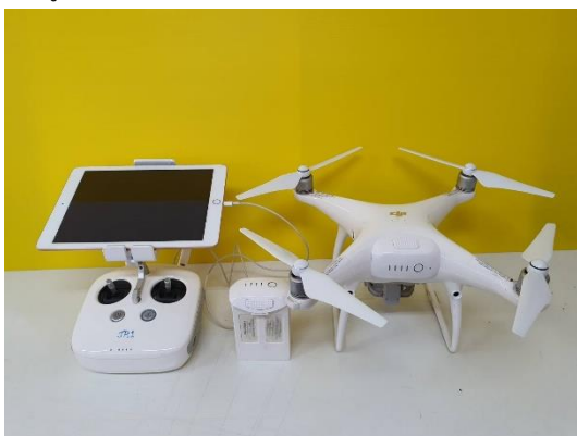
รูปที่ 3 อากาศยานไร้คนขับแบบปีกหมุนDJI-Phantom 4 Pro
