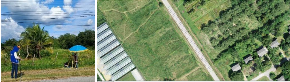
รูปที่ 7 รังวัดค่าพิกัดจุดควบคุมภาพและจุดตรวจสอบภาพถ่าย
