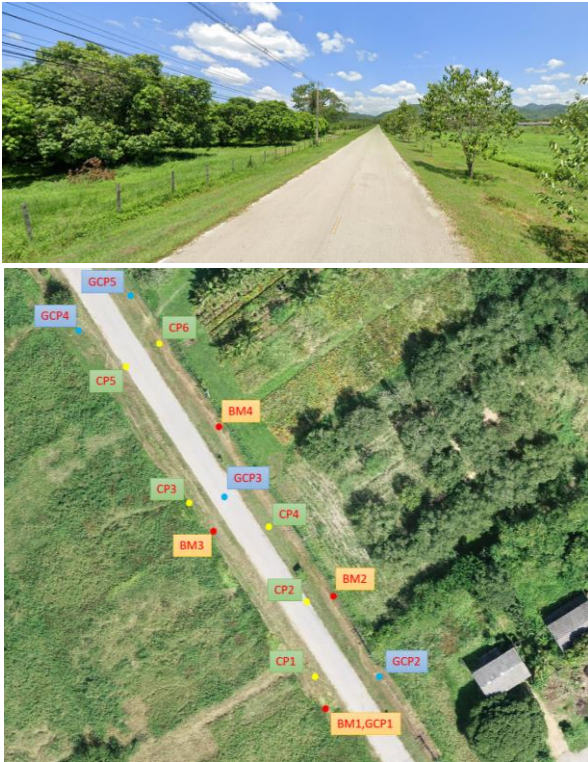
รูปที่ 1 พื้นที่วิจัยและผังการกำหนดหมุดสำรวจในสนาม
