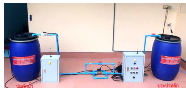
รูปที่ 11 ระบบจำลองการส่งน้ำประปาทางไกลผ่าน SMS
