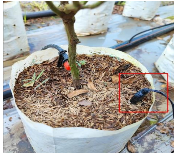
รูปที่ 15 ตำแหน่งการติดตั้งเซนเซอร์วัดความชื้นในดิน
