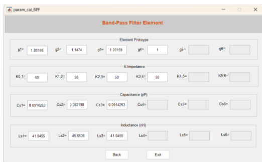
(ง) ค่าอุปกรณ์ของวงจรกรองผ่านแถบความถี่
