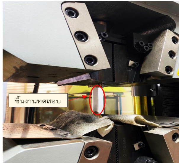
รูปที่ 6 การทดสอบความแข็งแรงดึงด้วยเครื่อง UTM
