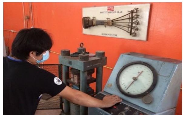
รูปที่ 13 ทดสอบความต้านทานแรงอัดของก้อนตัวอย่างอิฐบล็อกประสาน
