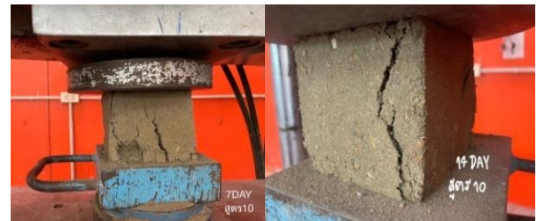
รูปที่ 12 ทดสอบความต้านทานแรงอัดของก้อนตัวอย่างคอนกรีตทรงลูกบาศก์
