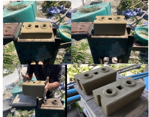
รูปที่ 11 การถอดแบบอิฐบล็อกประสานและบ่มในอากาศ
