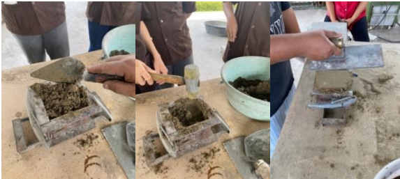
รูปที่ 7 อัดส่วนผสมลงในแบบหล่อ ขนาด 10 \times 10 \times 10 ซม.
