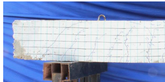
รูปที่ 11 รูปแบบการวิบัติของตัวอย่าง M-CDR2 ที่เกิดขึ้นหลังเสร็จสิ้นการทดสอบ
