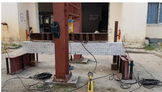
รูปที่ 5 การติดตั้งตัวอย่างคานและเครื่องมือทดสอบ
