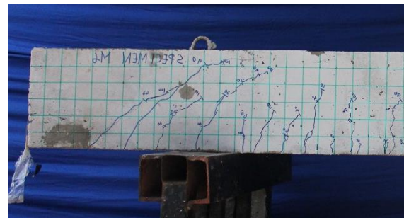
รูปที่ 12 รูปแบบการวิบัติของตัวอย่าง M-CDR3 ที่เกิดขึ้นหลังเสร็จสิ้นการทดสอบ
