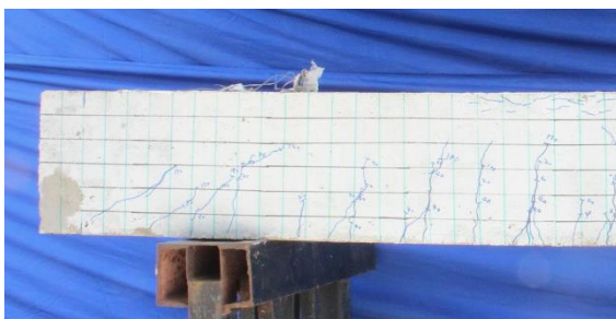
รูปที่ 10 รูปแบบการวิบัติของตัวอย่าง M-CDR1 ที่เกิดขึ้นหลังเสร็จสิ้นการทดสอบ
