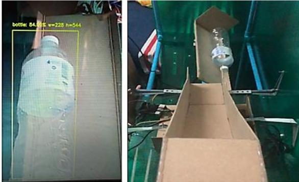
รูปที่ 7 ภาพตัวอย่างผลการตรวจสอบและรับขวดพลาสติก โดยระบบสามารถระบุได้ว่าวัตถุที่ถูกป้อนเข้าไปเป็น ขวดและค่าความเชื่อมั่นเป็น 84.99 เปอร์เซ็นต์ เมื่อเงื่อนไขในการตรวจสอบครบถ้วนคือ มีน้ำหนัก และค่าความเชื่อมั่นอยู่ในเกณฑ์ที่กำหนด (ซึ่งผู้วิจัยได้กำหนดค่าความเชื่อมั่นต่ำสุดที่ยอมรับได้คือค่าความน่าจะเป็นอยู่ที่ 0.2) ระบบจะทำการรับ ขวดโดยสั่งการให้ เซอร์โวมอเตอร์ตัวที่ 1 หมุนตามเข็มนาฬิกา ไปอีก 35 องศาเพื่อทำให้ฐานรองขวดพลิกและทำให้ขวดลง ทางช่องเก็บด้านขวามือและหมุนกลับมายังตำแหน่งเดิม
