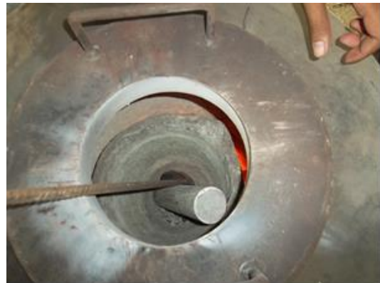
รูปที่ 9 ใส่อะลูมิเนียมลงในเข้าหลอม
