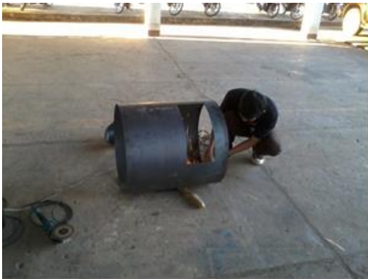
รูปที่ 2 การม้วนเหล็กเป็นรูปทรงกระบอก และการเจาะช่องเพื่อใส่ปล่องท่ออากาศ
