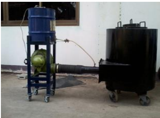
รูปที่ 6 เตาหลอมอะลูมิเนียม
