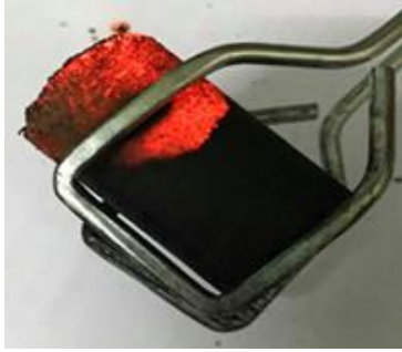
รูปที่ 12 ระยะทางการเผาไหม้ของก้อนถ่านอัดแท่งแบบผสมแอลกอฮอล์แข็ง สูตรที่ 4 เมื่อเวลาผ่านไป 5 นาที
