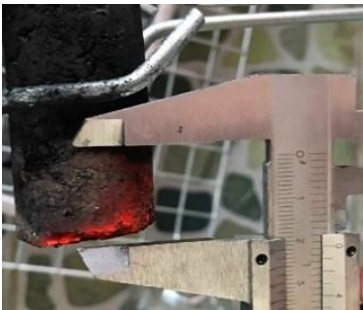
รูปที่ 14 ระยะทางการเผาไหม้ของก้อนถ่านอัดแท่งแบบชุบเคลือบแอลกอฮอล์แข็ง หรือสูตรที่ 6 เมื่อเวลาผ่านไป 5 นาที
