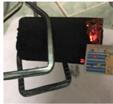
รูปที่ 9 ระยะทางการเผาไหม้ของก้อนถ่านอัดแท่งแบบไม่ผสมแอลกอฮอล์แข็ง หรือสูตรที่ 1 เมื่อเวลาผ่านไป 5 นาที
