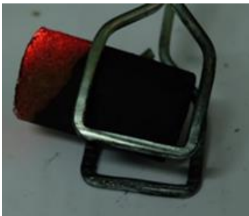
รูปที่ 13 ระยะทางการเผาไหม้ของก้อนถ่านอัดแท่งแบบผสมแอลกอฮอล์แข็ง สูตรที่ 5 เมื่อเวลาผ่านไป 5 นาที
