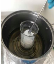
รูปที่ 5 แอลกอฮอล์แข็งที่ถูกนำไปให้ความร้อนจากเตาไฟฟ้าและถ่านน้ำมันร้อน ที่อุณหภูมิ 80 องศาเซลเซียส ระยะเวลา 20 นาที
