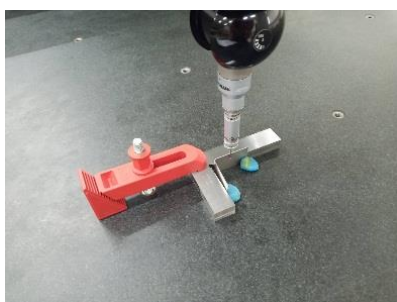
รูปที่ 9 วัดมุมขึ้นงานด้วยเครื่อง CMM
