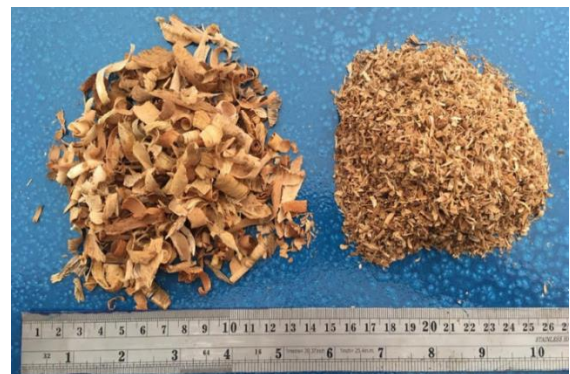
รูปที่ 9 ผลการใช้งานเครื่องบดเศษไม้ให้เป็นชิ้นเล็กแบบสองชุดบดเปรียบเทียบ เศษกลิ้งของไม้มะม่วงก่อนและหลังการบด
