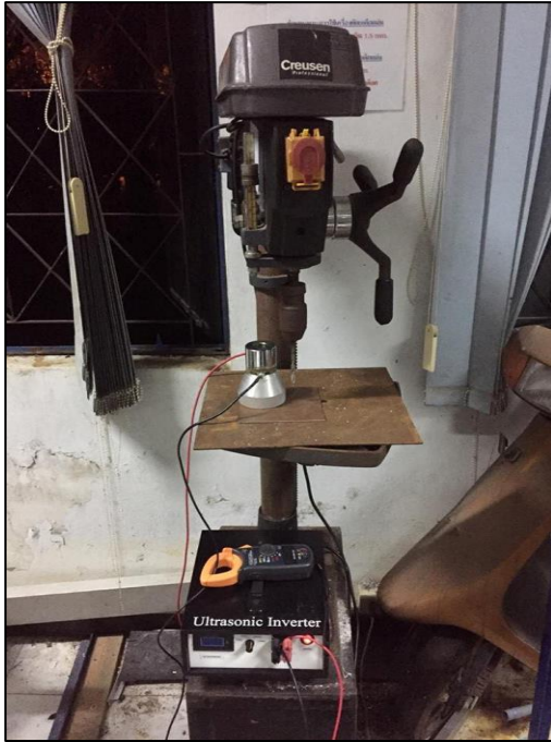
รูปที่ 12 การทดสอบเจาะแผ่นวัสดุตัวอย่าง และบันทึกผลการวัด
