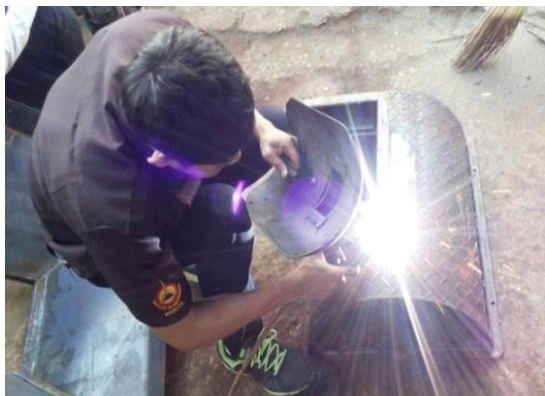
รูปที่ 3 การสร้างถังย่อยดินด้านบน
