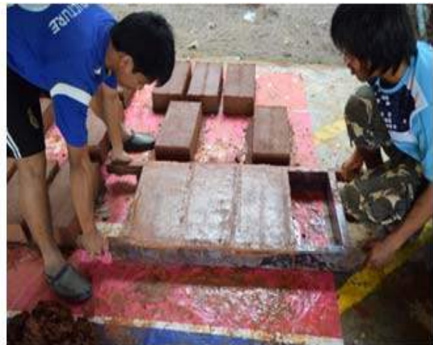
รูปที่ 2 การขึ้นรูปก้อนอิฐดินดิบ
