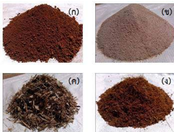
รูปที่ 1 วัสดุที่ใช้ทำก้อนอิฐดินดิบ (ก) ดิน (ข) ทรายละเอียด (ค) ใบกล้วยบด (ง) ขุยมะพร้าว
