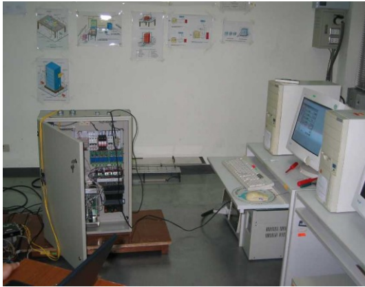
รูปที่ 11 การทดสอบ EFT ของหน่วยวัดคุมระยะไกล
